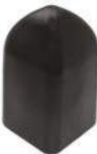
MTP 2059P BATENTE SUSP. MOLA DIANTEIRA (MAIOR) SUBST. CÔD. ORIG.: A355 331 00 44 VEÍCULO: Compatível MB 1513/ 1938/ 2013/ 2219 DIMENSÕES: Alt. 99,5mm x Base 58,45mm MATERIAL: Poliuretano Shore 85
