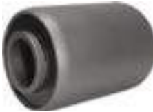
MTP 3290P BUCHA DA BARRA ESTAB. TRASEIRA SUBST. CÔD. ORIG.:20589549/20498824/ 20500857 VEÍCULO: VM 6x4 Traçado DIMENSÕES: Ext. 45mm x Int. 20mm x Comp. 66mm MATERIAL: Tubo SAE 1020 e TPE Shore 85
