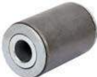
MTP 4629P BUCHA DA MOLA E SUPORTE DA SUSP. DIANTEIRA SUBST. CÔD. ORIG.:21 175 831 VEÍCULO: Compatível Volvo FH 2015 (todos) DIMENSÕES: Ext. 61mm x Int. 24,2mm x Comp. 96mm MATERIAL: GGG40 Fundido e TPE Shore 85
