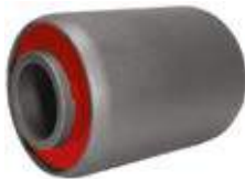
PU 3290 BUCHA DA BARRA ESTAB. TRASEIRA SUBST. CÔD. ORIG.:20589549/20498824/ 20500857 VEÍCULO: VM 6x4 Traçado DIMENSÕES: Ext. 45mm x Int. 20mm x Comp. 66mm MATERIAL: Tubo SAE 1020 e Poliuretano Shore 70
