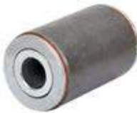
PU 4629 BUCHA DA MOLA E SUPORTE DA SUSP. DIANTEIRA SUBST. CÔD. ORIG.:21 175 831 VEÍCULO: Compatível Volvo FH 2015 (todos) DIMENSÕES: Ext. 61mm x Int. 24,2mm x Comp. 96mm MATERIAL: GGG40 Fundido e Poliuretano Shore 70
