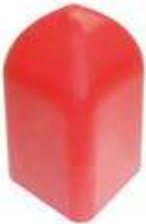
PU 2059 BATENTE SUSP. MOLA DIANTEIRA (MAIOR) SUBST. CÔD. ORIG.: A355 331 00 44 VEÍCULO: Compatível MB 1513/ 1938/ 2013/ 2219 DIMENSÕES: Alt. 99,5mm x Base 58,45mm MATERIAL: Poliuretano Shore 70
