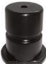
MTP 2142P BATENTE SUSP. MOLA DIANTEIRA SUBST. CÔD. ORIG.: A384 324 70 08 VEÍCULO: Compatível MB OF 1318/OF 1618/ OF 1620/OF 1721 DIMENSÕES: Alt. 85mm x Larg. Aba 60mm x Aba 79mm MATERIAL: TPE Shore 85
