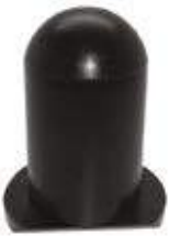
MTP 2160P BATENTE SUSP. MOLA DIANTEIRA (MOLA AUXILIAR) SUBST. CÔD. ORIG.: A000 324 09 08 VEÍCULO: Compatível MB Axor DIMENSÕES: Alt. 114mm x Base 90mm x 61,2mm x Larg. Aba 60mm MATERIAL: TPE Shore 85
