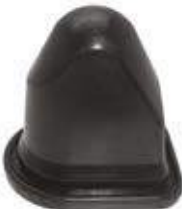
MTP 2158P BATENTE DA MOLA DIANTEIRA SUBST. CÔD. ORIG.: A6753 240 008 /A6763 240 108 VEÍCULO: Compatível MB Atego DIMENSÕES: Alt. 85mm x Base 88mm x 68mm MATERIAL: TPE Shore 85
