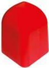
PU 2029 BATENTE MOLA DIANTEIRA SUBST. CÔD. ORIG.: A352 331 00 44 VEÍCULO: Compatível MB 1113/1313/ O400RS-RSD DIMENSÕES: Alt. 83,23mm x Base 58,8mm MATERIAL: Poliuretano Shore 70
