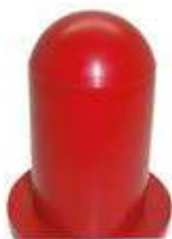
PU 2160 BATENTE SUSP. MOLA DIANTEIRA (MOLA AUXILIAR) SUBST. CÔD. ORIG.: A000 324 09 08 VEÍCULO: Compatível MB Axor DIMENSÕES: Alt. 114mm x Base 90mm x 61,2mm x Larg. Aba 60mm MATERIAL: Poliuretano Shore 70
