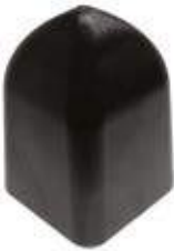
MTP 2029P BATENTE MOLA DIANTEIRA SUBST. CÔD. ORIG.: A352 331 00 44 VEÍCULO: Compatível MB 1113/1313/ O400RS-RSD DIMENSÕES: Alt. 83,23mm x Base 58,8mm MATERIAL: TPE Shore 85
